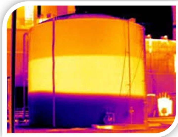
شکل (۴) عکس حرارتی مخزن سوخت در یک نیروگاه
